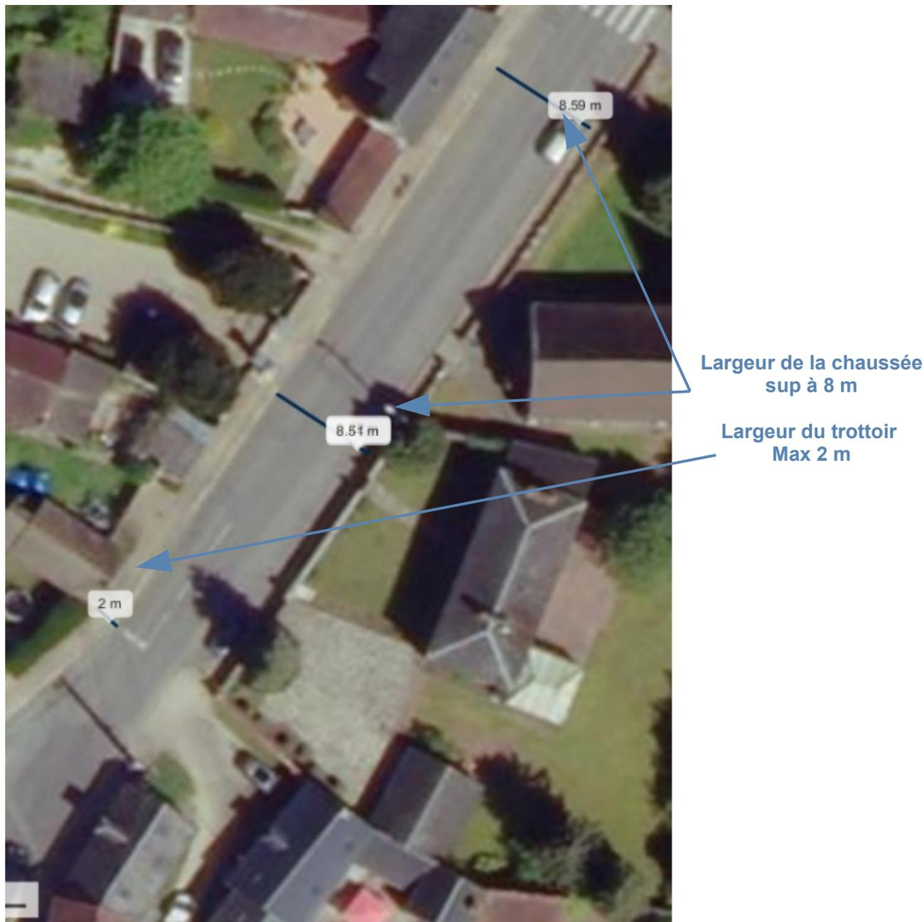
Fig.12 .a : Mesures du trottoir et de la chaussée après la rue du Bout Sec
